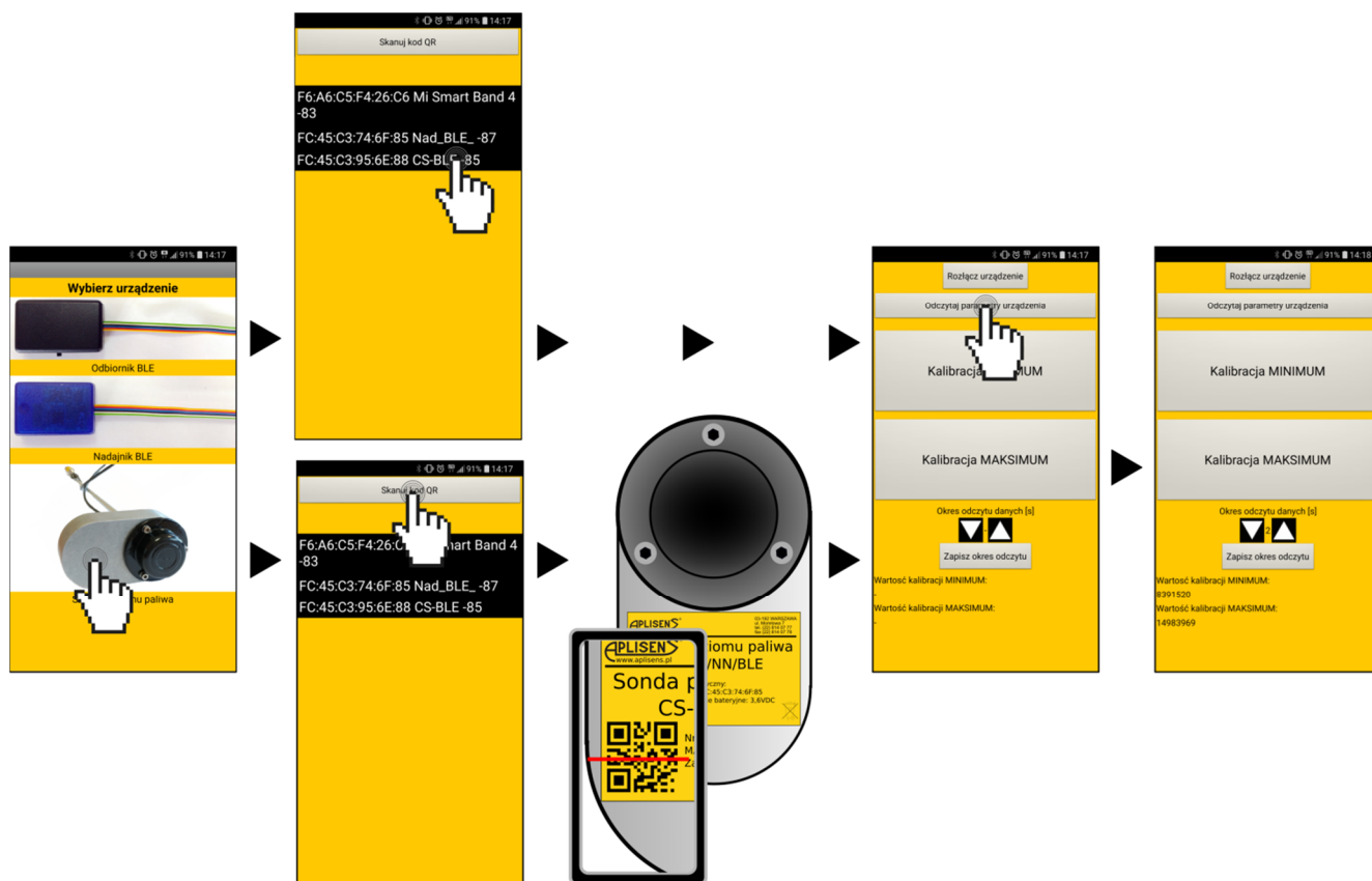
Rys. 7 Połączenie z sondą i odczyt parametrów.
