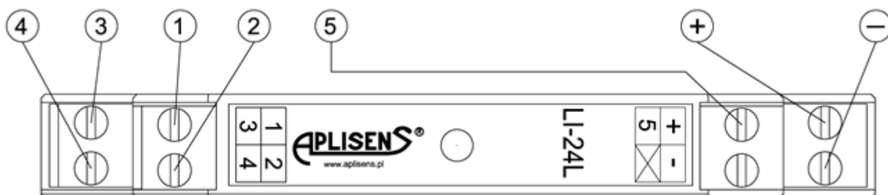
Rysunek 8. Oznaczenia zacisków przetwornika LI-24L.
